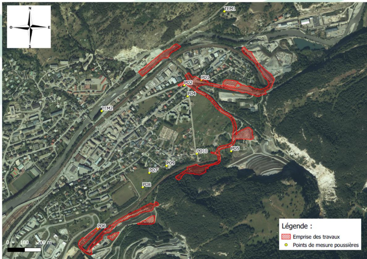
Méthode de mesure des retombées de poussières selon la norme NF X 43-014 : Suivi en continu par prélèvement sur jauges pendant une durée de 1 mois, analyse de la quantité de poussières collectées
